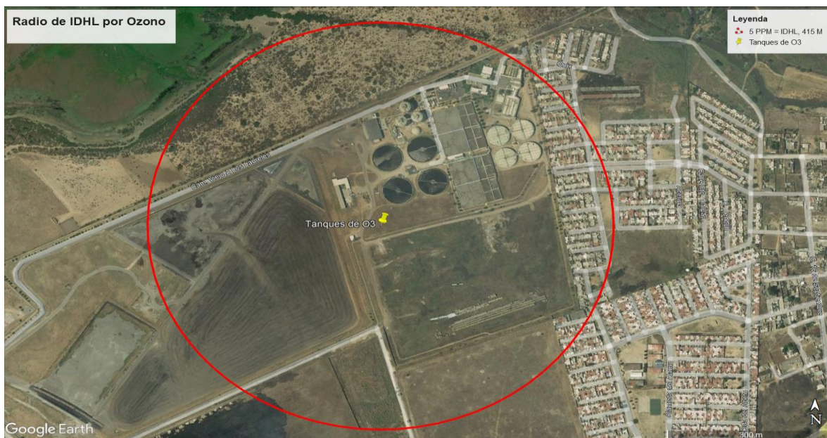
Figura 2. Radio de 415 m por IDHL por toxicidad en fuga de ozono
