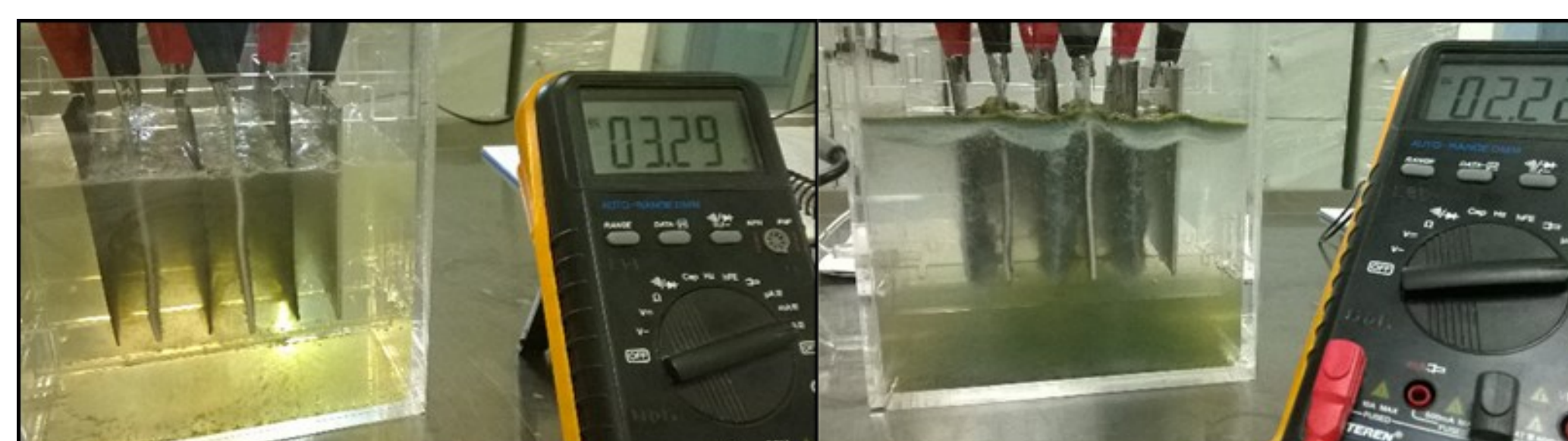
Figura 5. Tratamiento por ECAC. Lado izquierdo: agua sin tratar. Lado derecho: 15 min de tratamiento
